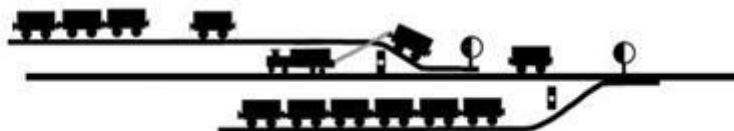
Slika 1b: Premaknitev vozila, kadar je prost le en tir. Vozilo se prestavlja z ene strani postaje na drugo.
