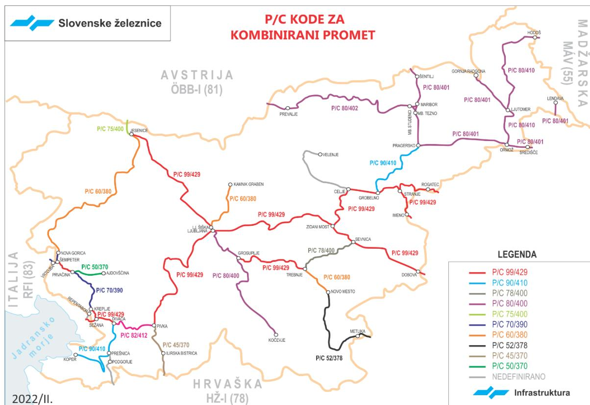
Glede na največje dopustne dimenzijs vozil in naklada se proge delijo po vrstah dopustnih nakladalnih profilov. Vse proge JŽI dovoljujejo prevoz vozil in tovora v skladu z mednarodnim nakladalnim profilom, nakladalnim profilom SŽ I ter nakladalnim profilom za kombinirani transport GA in GB. Nakladalni Profil SŽ I in mednarodni nakladalni profil sta prikazana v prilogi 2D.
