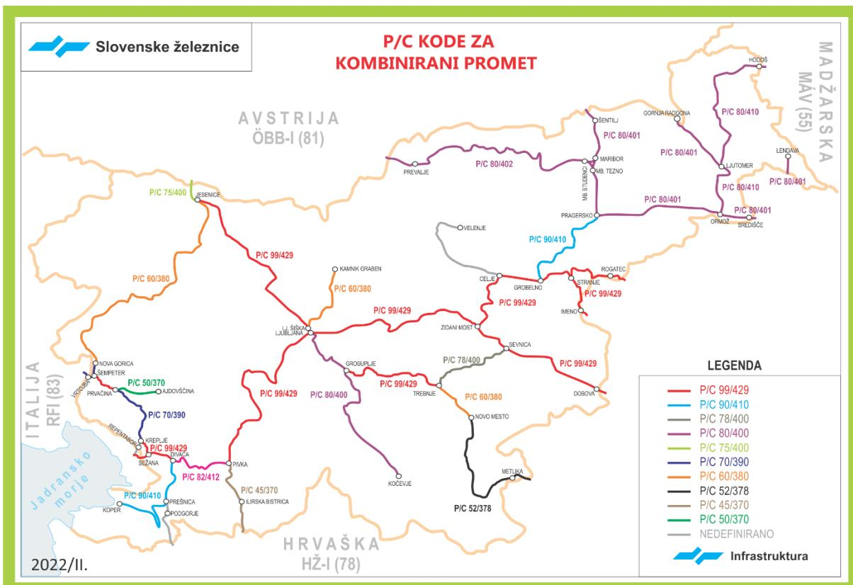
Glede na največje dopustne dimenzije vozil in naklada se proge delijo po vrstah dopustnih nakladalnih profilov. Vse proge JŽI dovoljujejo prevoz vozil in tovora v skladu z mednarodnim nakladalnim profilom, nakladalnim profilom SŽ I ter nakladalnim profilom za kombinirani transport GA in GB. Nakladalni Profil SŽ I in mednarodni nakladalni profil sta prikazana v prilogi 2D.
